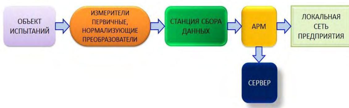
Рис. 1. Типовая структурная схема ИИС
