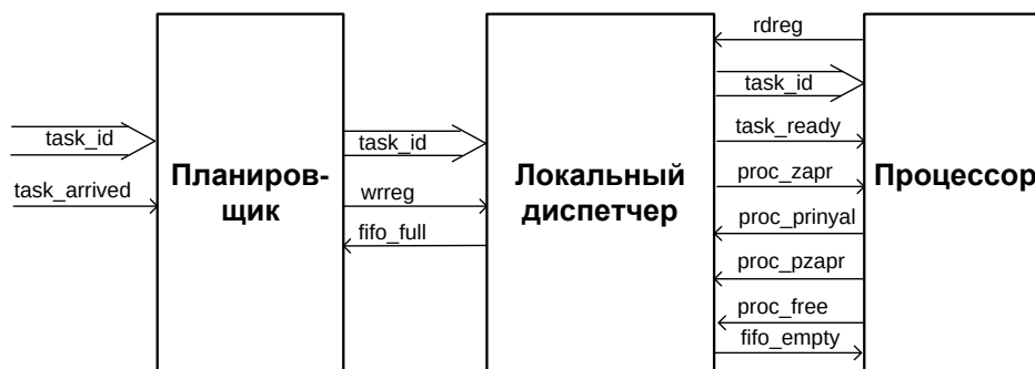
Рис. 2. Интерфейс взаимодействия локального диспетчера с планировщиком задач и процессором
