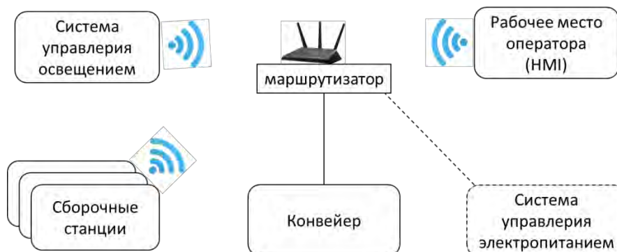
Рис. 3. Схема учебной производственной системы
