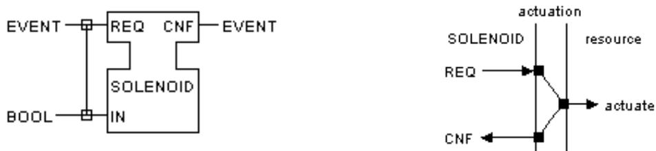
Рис. 2.10. СИФБ *SOLENOID*: интерфейс (слева) и временная последовательность работы (справа)
