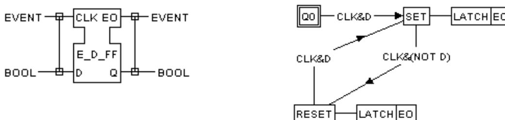
Рис. 1.6. Базисный ФБ «*D*-триггер»: интерфейс (слева) и диаграмма *ЕСС* (справа) [163]
