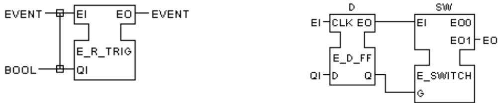
Рис. 1.7. Составной ФБ «D-триггер», срабатывающий по переднему фронту: интерфейс (слева) и сеть ФБ (справа) [163]
