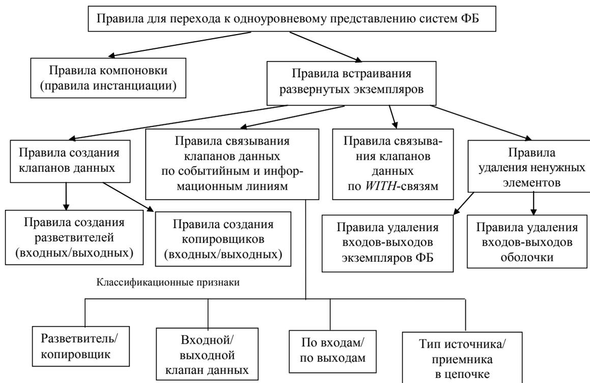
Рис. 5.34. Классификация правил перехода от многоуровневой структуры систем ФБ к одноуровневой структуре
