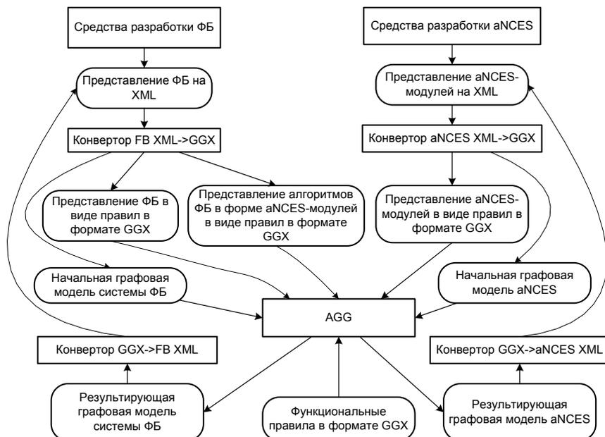
Рис. 5.52. Структура системы синтеза формальных моделей ФБ
