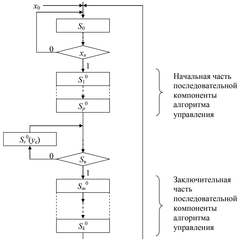
Рис. 5.3. ГСА главного п/А, реализующего начальную и заключительную части последовательной компоненты алгоритма управления
